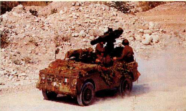
Sistema d'arma controcarro Tow su autovettura da ricognizione AR 76 della compagnia controcarri Julia in movimento durante la fase di contrasto della penetrazione da nord
