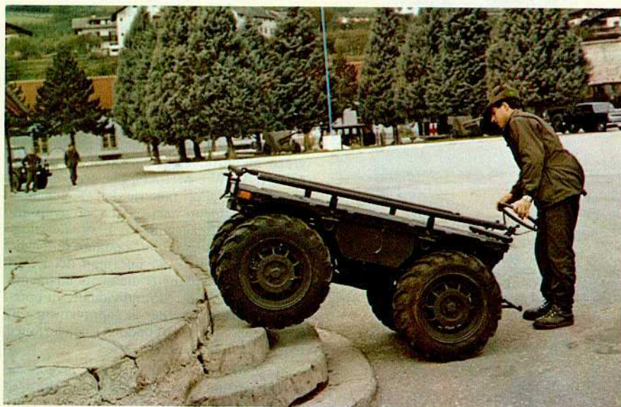
Il motocarrello «m.t.c. 80» è un ingegnoso e validissimo mezzo di trasporto, sostitutivo del mulo, capace di muoversi su mulattiere
