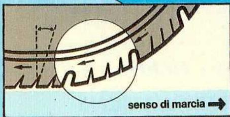
L'inclinazione delle lamelle (brevetto esclusivo Michelin) determina la loro apertura in fase di contatto al suolo. Eccezionale aderenza su neve e ghiaccio senza ricorrere alla chiodatura. Confortevole e silenzioso su strada asciutta (160 km/h).
